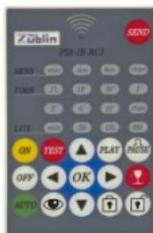
**Achtung!** Reglerwerte werden durch manuelles Ändern der Werte LUX oder TIME während dem Betrieb sofort aktiv (bzw. neu gespeichert) und alle per Fernbedienung programmierten Parameter werden gelöscht! Es können entweder die Reglerwerte oder die Fernbedienungswerte aktiv sein. Ein „Mischen“ ist nicht möglich.
