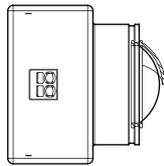
Befestigen Sie die Abdeckung für den Erkennungsbereich am Sensor, indem Sie sie in die entsprechende Nut an der Vorderseite des Sensors einführen.
