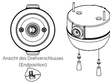
Nach dem losen Anbringen der Abdeckung auf der Grundplatte die beiden Schrauben eindrehen und festziehen. Im letzten Schritt die Verschlusskappen einsetzen.
