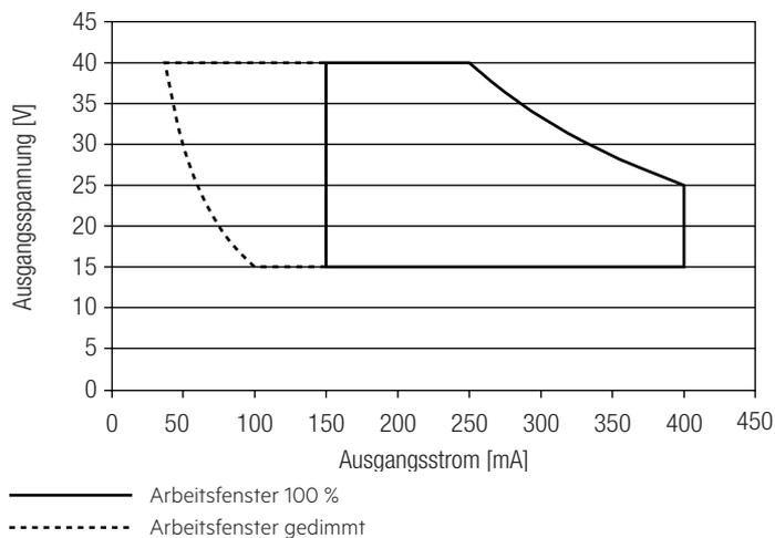
Es ist sicherzustellen, dass der LED-Treiber ausschließlich innerhalb des gezeigten Arbeitsfensters betrieben wird. Besondere Aufmerksamkeit ist dem gedimmten Betrieb sowie dem DC- und Notlichtbetrieb zu widmen, da aufgrund der verwendeten Amplituden-Dimmung die Modulspannung mit dem Dimm-Level variiert. Eine Unterschreitung der spezifizierten minimalen Ausgangs-
