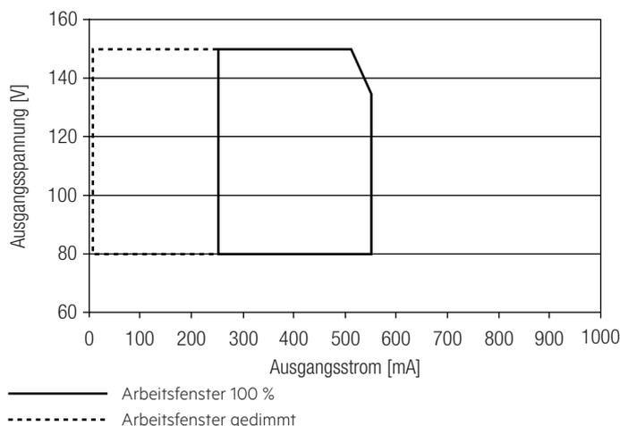
Es ist sicherzustellen, dass der LED-Treiber ausschließlich innerhalb des gezeigten Arbeitsfensters betrieben wird. Besondere Aufmerksamkeit ist dem gedimmten Betrieb sowie dem DC- und Notlichtbetrieb zu widmen, da aufgrund der verwendeten Amplituden-Dimmmung die Modulspannung mit dem Dimm-Level variiert. Eine Unterschreitung der spezifizierten minimalen Ausgangsspannung des LED-Treibers kann zur Abschaltung führen. Siehe Abschnitt „6.11 Lichtlevel im DC-Betrieb“ für mehr Informationen.
