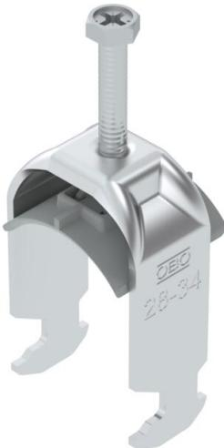
Bügelschelle mit Hammerkopf-Fuß, Kunststoffdruckwanne aus Polypropylen. Zur vertikalen und horizontalen Montage von 1 Einzelkabel an C-Proflschiene. Für Schlitzweite 16 - 17 mm. Mit 1-gängiger Schraube an Druckwanne, universeller Sechskant-Schraubenkopf SW10, mit Schlitz und Kreuzschlitz. Geeignet für Montage im Innen-und Außenbereich. Der Einsatz einer Gegenwanne wird empfohlen.
