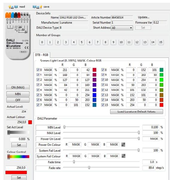
Einstellmöglichkeiten für jeden Kanal in der Betriebsart Colour&Dim:
