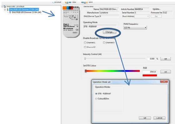
Außerdem kann auf der Übersichtsseite die PWM-Frequenz gewählt werden und in jeder Betriebsart stehen Steuerelemente zum Testen der Funktion zur Verfügung (Schieber für Helligkeit und Farbe im DT8 und Colour&Dim Mode). Optional kann auch die Broadcaststeuerung einzelner Kanäle deaktiviert werden.
