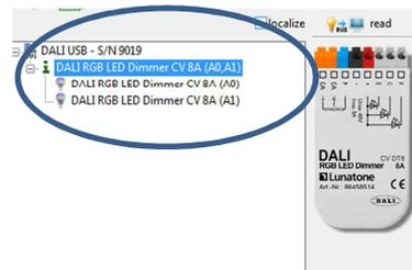
Einstellmöglichkeiten in der Betriebsart DT8 (angezeigte Parameter entsprechen dem Auslieferungszustand):
