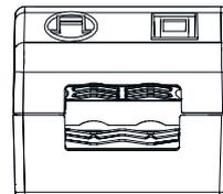
Sekundäre Zugentlastung für Kabel mit kleinerem Kabelmantel
