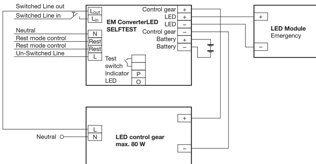
EM converterLED SELFTEST mit einem Standard LED-Betriebsgerät und LED-Modulen in Serie
