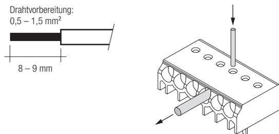
Draht lösen durch Drehen und Ziehen oder Verwendung eines Lösewerkzeugs Ø 1 mm
