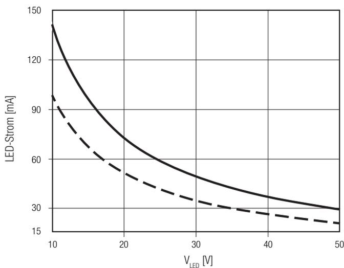
LED-Strom bei nominaler Akkuspannung und min. Akkuentladestrom
