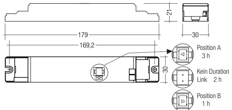
Hinweis: Lieferung Betriebsgerät mit Duration Link in 3 Stunden-Position. Duration Link für Betriebsdauer vor Akku - und Netzanschluss einstellen.
