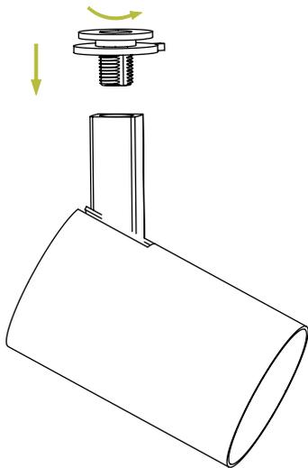
2. Der Nippel wird im Treiber eingesetzt.
