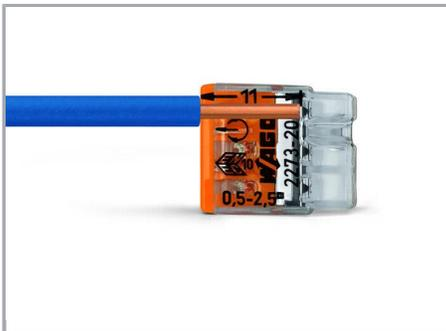
Eindrätigen Leiter gemäß dem aufgedruckten Maß 11 mm abisolieren.
