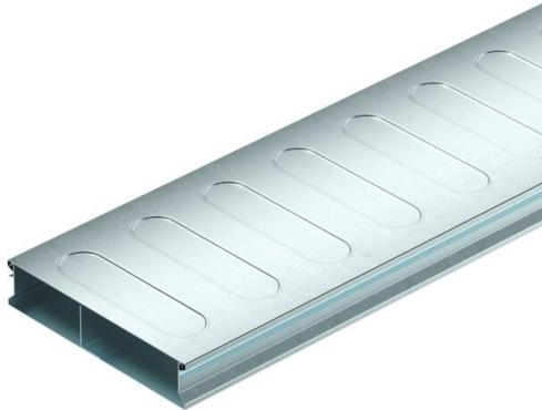
Unterflurkanal (2-teilig) zur Verlegung von Kabeln und Leitungen in estrichüberdeckten Unterflur-Systemen nach EN 50085-2-2. Abnehmbarer und durchgängig aufrastbarer Kanaldeckel. Mit Trennsteg im Kanalunterteil. Maximale Belastbarkeit bis 1,5 kN.
