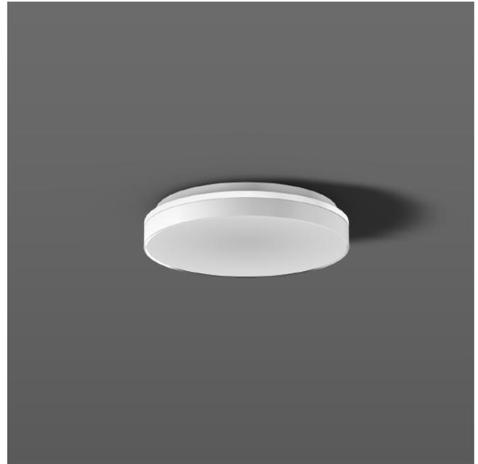
Decken- und Wandleuchte im minimalistischen Design. Gehäuse Kunststoff (Polycarbonat). Diffusor Kunststoff (Polycarbonat) opal. Gehäuse und Diffusor fest verbunden. MultiColour: Farbtemperatur mit Schaltelement einstellbar. Auswahlmöglichkeit 3000 K oder 4000 K. Werkseitig auf 3000 K eingestellt. Schnellmontageadapter Stahlblech verzinkt, mit Befestigungsschrauben. Betriebsgerät integriert.
