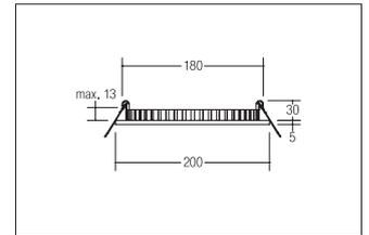
LED-RGB-Einbaupanel FLAT30, weiß. Ausgeführt in kompakter Bauform für werkzeuglose Schnellmontage zum Deckeneinbau. Fassung: ohne, Montageart: Einbaumontage, Montageort: Deckenmontage, Material: Aluminium / Kunststoff, Schutzart: nach DIN EN 60529: IP20, Schutzklasse: (EN 61140) III, Spannung: 24V, Leistung: 13W, Anzahl der Leuchtmittel / Fassungen: 1.0 Stk, Abstrahlwinkel: 120°, Verstellbarkeit: nicht verstellbar, ohne Betriebsgerät, Art der Dimmung: sonstige, .
