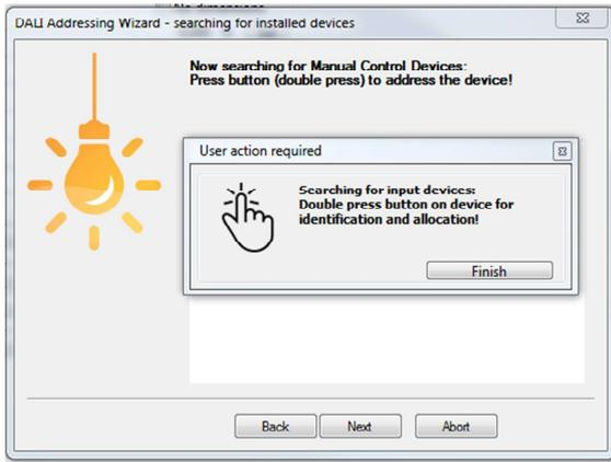
Das DALI Touch wird erkannt und eine Adresse zugewiesen. Im Anschluss kann das Gerät konfiguriert werden.
