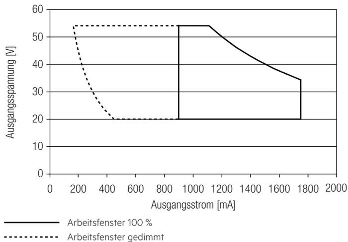
Es ist sicherzustellen, dass der LED-Treiber ausschließlich innerhalb des gezeigten Arbeitsfensters betrieben wird. Besondere Aufmerksamkeit ist dem gedimmten Betrieb sowie dem DC- und Notlichtbetrieb zu widmen, da aufgrund der verwendeten Amplituden-Dimmung die Modulspannung mit dem Dimm-Level variiert. Eine Unterschreitung der spezifizierten minimalen Ausgangsspannung des LED-Treibers kann zur Abschaltung führen. Siehe Abschnitt „6.8 DC- und Notlichtbetrieb“ für mehr Informationen.
