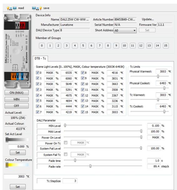
Neben den DALI-Parametern bietet die Seite mit der einstellbaren Schrittweite (Tc-Stepsize) eine einfache Möglichkeit die Geschwindigkeit der Farbtemperaturverstellung bei Verwendung der Befehle TC STEP COOLER/WARMER zu beeinflussen.
