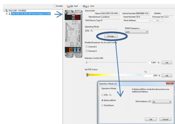
Außerdem kann auf der Übersichtsseite die PWM-Frequenz eingestellt werden und es stehen in jeder Betriebsart Steuerelemente zum Testen der Funktion zur Verfügung, in der Betriebsart DT8-Tc sind dies Schieber zum Verstellen von Helligkeit und Farbtemperatur.
