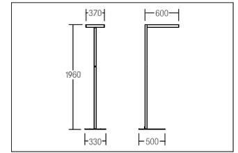
LED-Stehleuchte BIRO60, mikroprismatische Abdeckung mit Indirektanteil, silber. Ausführung in kompakter Bauform für die harmonische Implementierung in stimmige, architektonische Raumkonzepte.
