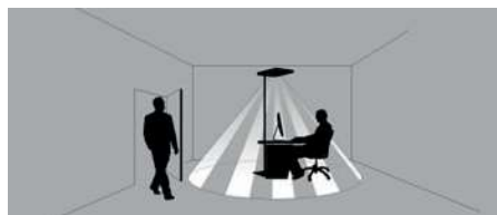
Fig. 12: Campo d'azione di PULSE PIR.
