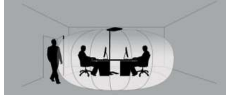
Fig. 11: Erfassungsbereich PULSE HFMD.
