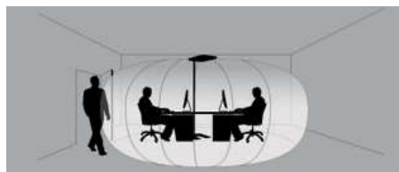
Fig. 11: Zone de détection de PULSE HFMD.
