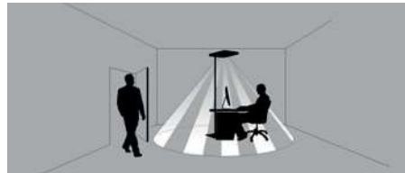
Fig. 12: Erfassungsbereich PULSE PIR.
