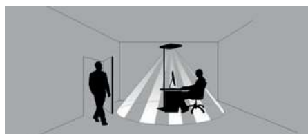
Fig. 12: Zone de détection de PULSE PIR.
