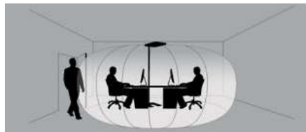
Fig. 11: Campo d'azione di PULSE HFMD.
