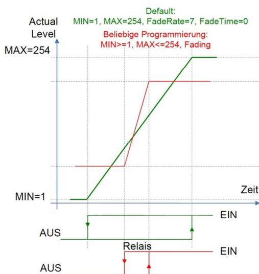
Einschalten erfolgt wenn der ACTUAL LEVEL den MAX-Wert überschreitet, ausschalten erfolgt hingegen bei Unterschreiten des MIN-Werts. Auf den Actual Level werden die Fading-Parameter wie im DALI-Standard
