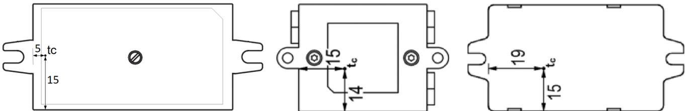
Achten Sie beim Einbau auf die Lage der Antenne und vermeiden Sie größere metallische Umbauungen oder planen Sie ggf. eine Aussparung für die Antenne ein. Es empfiehlt sich bei allen Umbauungen die Reichweite zu testen. Die Lage und Größe der empfohlenen Aussparungen können Sie der folgenden Zeichnung entnehmen.
