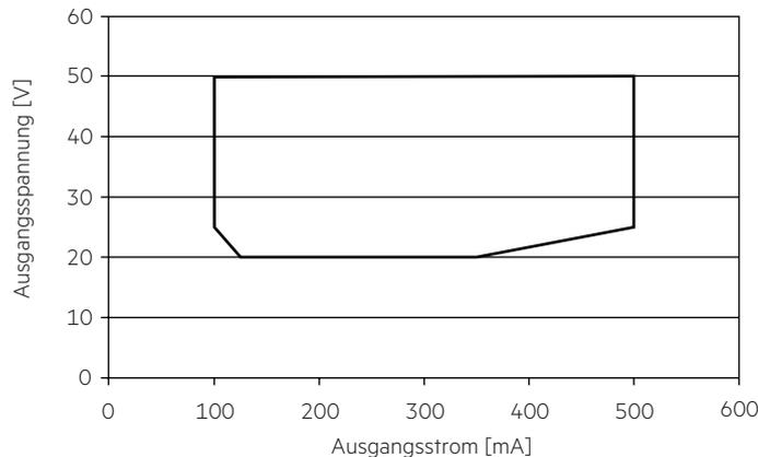
Es ist sicherzustellen, dass der LED-Treiber ausschließlich innerhalb des gezeigten Arbeitsfensters betrieben wird. Eine Unterschreitung der spezifizierten minimalen Ausgangsspannung des LED-Treibers kann zur Abschaltung führen.
