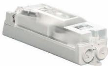
Kabelübergangskasten, für 3 Kabel bis 5x 10mm<sup>2</sup>, L1/L2/L3/N/PE(N), 2x E14, aus Kunststoff, schlagfest, Mastinnendurchmesser: ab 84mm, Schutzart (gesamt): IP44, Schutzklasse (gesamt): SK II (Schutzisoliert), Prüfzeichen: CE, Verpackungseinheit: 1 Stück
