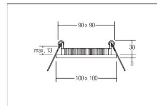
LED-RGB-Einbaupanel FLAT30, weiß. Ausgeführt in kompakter Bauform für werkzeuglose Schnellmontage zum Deckeneinbau. Fassung: ohne, Montageart: Einbaumontage, Montageort: Deckenmontage, Material: Aluminium / Kunststoff, Schutzart: nach DIN EN 60529: IP20, Schutzklasse: (EN 61140) III, Spannung: 24V, Leistung: 6W, Anzahl der Leuchtmittel / Fassungen: 1.0 Stk, Abstrahlwinkel: 120°, Verstellbarkeit: nicht verstellbar, ohne Betriebsgerät, Art der Dimmung: sonstige, .
