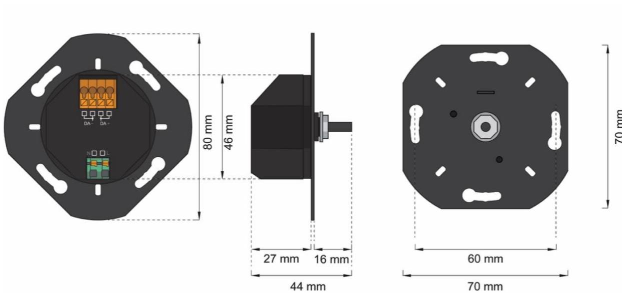
Abmessungen DALI ROT PS: 86459822-PS, 86459822-TW-PS, 86459822-RGB-PS, 86459822-RGBW-PS
