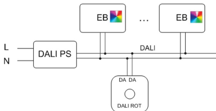
**Colour&Dim:** In Kombination mit Lunatone-Dimmern kann die Betriebsart Colour&Dim verwendet werden. In diesem Modus werden die Farbinformationen nicht mit Befehlen der DT8-Erweiterung sondern über eine separate Adresse übermittelt.
