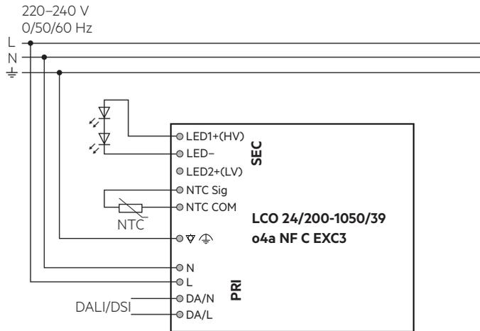
DALI mit Niederspannungsausgang (LV)
