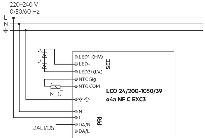
switchDIM mit Hochspannungsausgang (HV)
