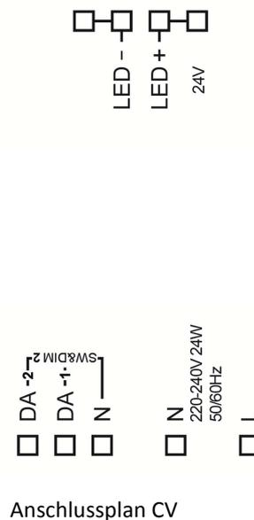
**EMPFEHLUNG:** Bei der Installation sollte darauf geachtet werden, die Leitungslängen zwischen LED-Power Supply und LED-Leuchten (LED-Strings) so kurz wie möglich zu halten um Einflüsse von Spannungsabfällen zu minimieren.
