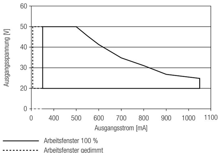
Es ist sicherzustellen, dass der LED-Driver in allen Betriebszuständen, auch im gedimmten Zustand, innerhalb des angeführten Fensters betrieben wird. Ansonsten können aufgrund der amplitudenmodulierten Dimm-Methode Limitierungen in Kraft treten. Eine Unterschreitung der spezifizierten minimalen Ausgangsspannung kann zur Abschaltung des LED-Driver führen. In diesem Zusammenhang ist spezielles Augenmerk auf den DC-Betrieb zu legen.
