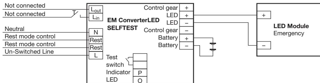
**EM converterLED SELFTEST mit einem Standard LED-Treiber und einem LED-Modul für Netz- und Bereitschafts-Notbetrieb**
