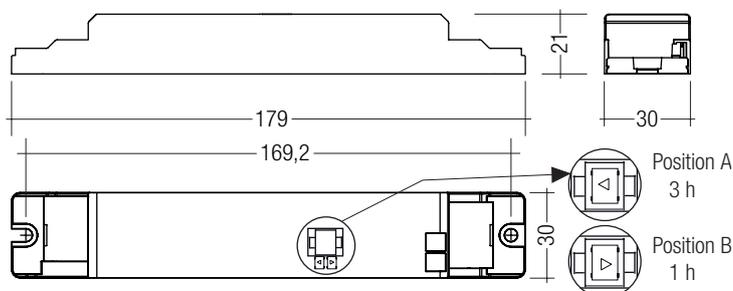
Hinweis: Lieferung LED-Treiber mit Duration Link in 3 Stunden-Position. Duration Link für Betriebsdauer vor Akku - und Netzanschluss einstellen. Das EM converterLED ST 134 NiCd wird ohne Duration Link geliefert. Die Bemessungsbetriebsdauer beträgt 3 Stunden und kann nicht geändert werden.
