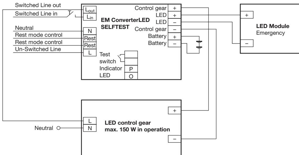
**EM converterLED SELFTEST mit einem Standard LED-Treiber und LED-Modulen in Serie**
