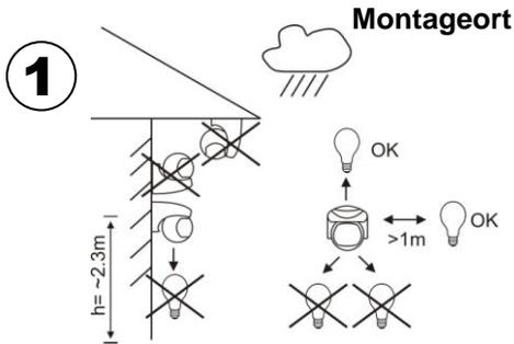
Um die Betriebssicherheit zu gewährleisten, montieren Sie den Melder an einem von der Witterung geschützten Ort. Vermeiden Sie Wärmequellen im unmittelbaren Erfassungsbereich sowie unterhalb des Melders.
