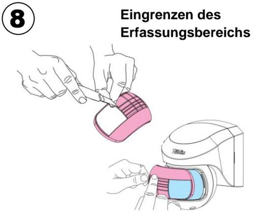
Bereiche können zum Test mit herkömmlichen Isolierband abgedeckt werden, bevor die Blende definitiv angepasst wird.
