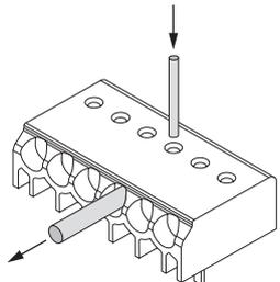
Draht lösen durch Drehen und Ziehen oder Verwendung eines Lösewerkzeugs Ø 1 mm
