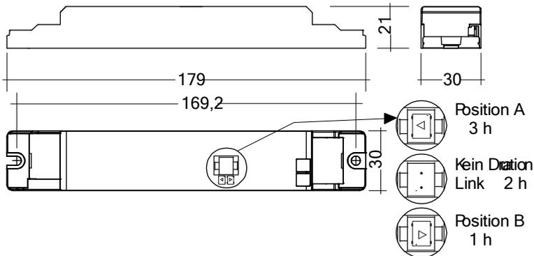
Hinweis: Lieferung LED-Treiber mit Duration Link in 3 Stunden-Position. Duration Link für Betriebsdauer vor Akku - und Netzanschluss einstellen.
