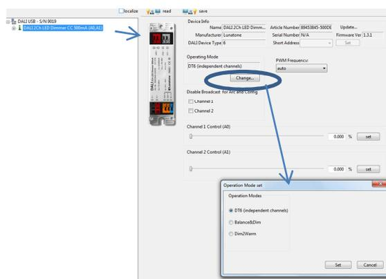
Außerdem kann auf der Übersichtsseite die PWM-Frequenz eingestellt werden und es stehen in jeder Betriebsart Steuerelemente zum Testen der Funktion zur Verfügung (DT6: Schieber für Helligkeit für jeden Kanal, Balance&Dim: Schieber für Helligkeit und
