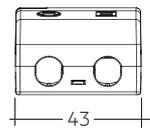
Erlaubter Kabelmantel-durchmesser: 2,2 – 9 mm
