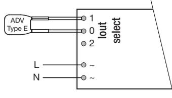
**1.100 mA:** Klemmen 0 und 1 verbunden mit 0 Ω Draht (max. 6 cm Länge) oder Widerstand ADV Plug Type A BR (Artikelnummer: 28001771)
