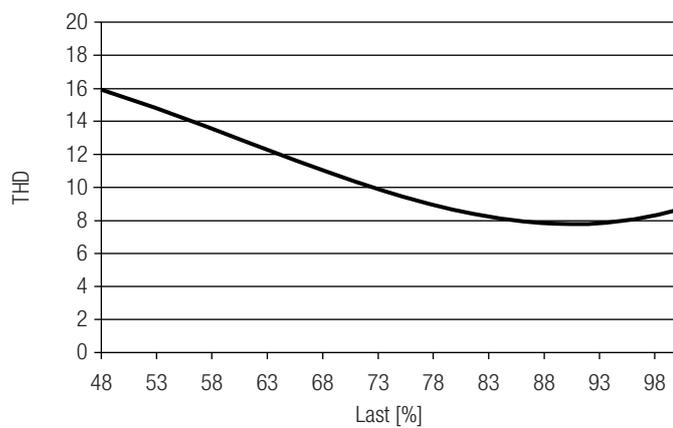
**Diagramme LC 30W 700mA fixC C ADV bei 230 V / 50 Hz**
