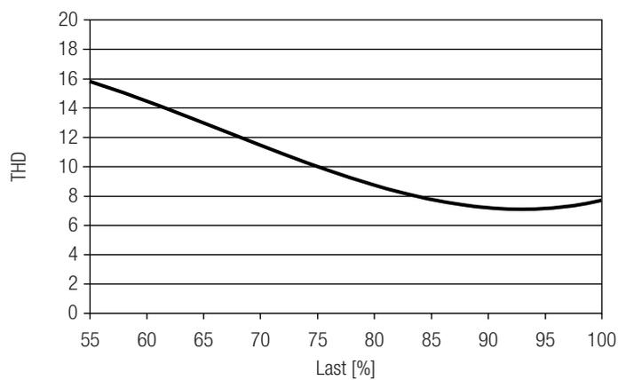
**Diagramme LC 40W 900mA fixC C ADV bei 230 V / 50 Hz**
