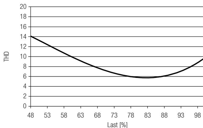
**Diagramme LC 35W 800mA fixC C ADV bei 230 V / 50 Hz**
