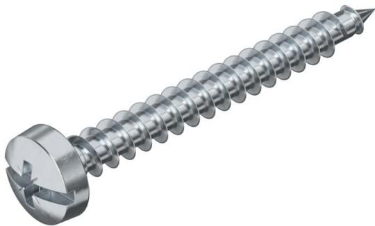
Stahl gehärtet, galvanisch verzinkt und hostaflonbeschichtet. Panhead mit kombiniertem Kreuz- und Schraubendreherschlitz (Pozidrive Gr. 2 außer Ø 6 mm Pozidrive Gr. 3).
