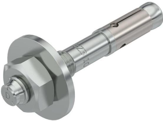
Bolzenanker BZ3 zur Verankerung mittelschwerer bis schwerer Lasten in gerissem oder ungerissenem Beton. Geeignet für hohe Lasten mit geringen Rand- und Achsenabständen. Zum Einschlagen.
