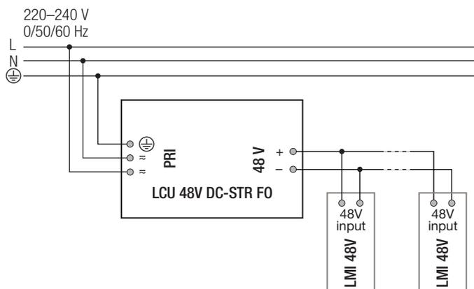
Am LCU 48V DC-STR FO können sowohl LMI 48V Fixed-output oder LMI 48V dimmbar angeschlossen werden. Wird das LCU 48V DC-STR FO zusammen mit den LMI 48V dimmbar, verwendet ist das Dimmen nicht möglich.
